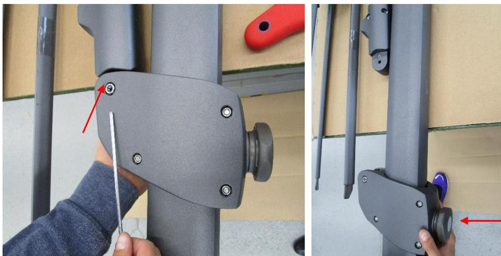
Una vez desmontado el carro, pueden soltarse los tres tornillos Allen en la parte inferior del brazo portante.
