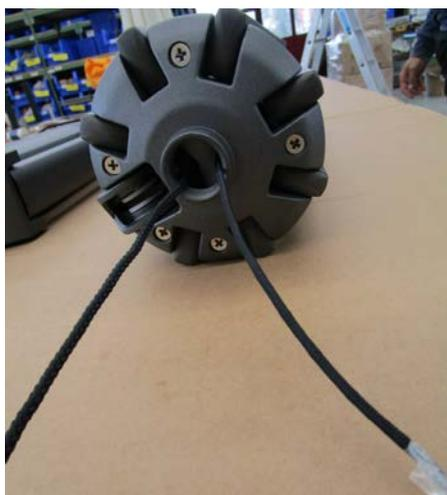
Wenn das Getriebe wieder zusammengebaut wird, auf die Rolle achten, da diese wegrutschen kann.
