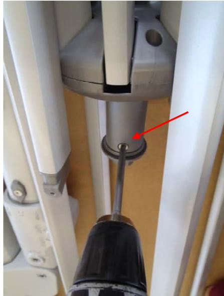
Strebe(n) nach aussen ziehen um die Seilspannung zu verringern. So gelangt man ans Seilende. Den Knoten lösen und den Haspel entfernen. Anschliessend die Strebe(n) langsam wieder sinken lassen.
