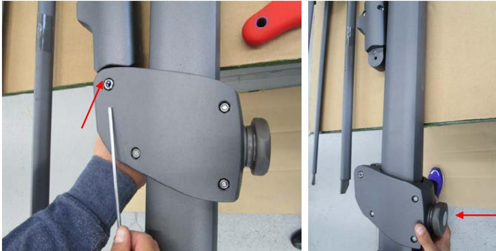
Nachdem der Wagen demontiert wurde, können die 3 Inbusschrauben unten am Tragarm gelöst werden.
