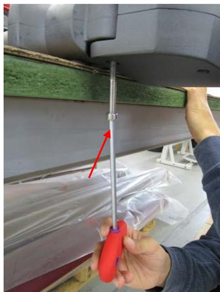
Die obere Zylinderschraube lösen.
