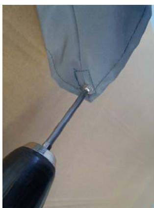
Um den Stoff ebenfalls am Tragarm zu entfernen, zuerst die Arretierung am Wagen lösen, diesen nach oben fahren, bis der Tragarm sich leicht absenkt. Anschliessend kann die Fixierschraube bequem gelöst werden.
